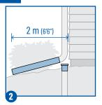
Débrancher les descentes pluviales, boucher les drains de fondation, et prolonger les descentes pluviales et les tuyaux d'évacuation des puisards pour diriger l'eau à au moins 2 m des fondations.
