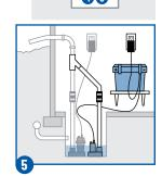
Installer une pompe de puisard de secours et une batterie.
