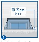
Installer des puits de fenêtre avec des margelles à au moins 10 à 15 cm du sol, et couvercles (lorsque les exigences en matière d'évacuation en cas d'incendie le permettent).
